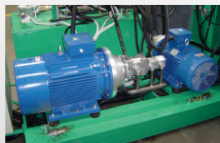
辊子回转、辊子移动的电气、液压回路相互独立，可同时承受最大载荷
