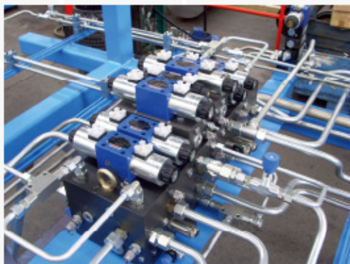
SERTOM 自制的整体式主阀体、金属液压管，最大限度降低故障发生的可能
