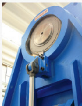
上辊一端的液压打开机构
